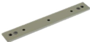
Планка для крепления замка. К замкам серии: ML-100K/-180K. Габаритные размеры: 180x24 мм. Масса брутто 320 г. Цвет серый, коричневый.
