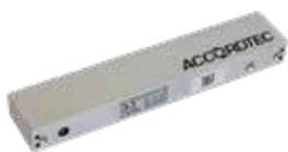
Электромагнитный замок, 12V/24V DC, не более 0,48 А, усилие 280 кг, габаритные размеры 253x43x28 мм. Масса брутто 1930 г., офисный дизайн, планка в комплекте. Механический компенсатор эффекта остаточной намагниченности на якоре замка.
