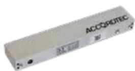
Электромагнитный замок, 12V/24V DC, не более 0,48 А, усилие 280 кг, габаритные размеры 253x43x28 мм. Масса брутто 2000 г., офисный дизайн, планка в комплекте, световая индикация, Датчик Холла положения замка (выход реле НО, НЗ). Механический компенсатор эффекта остаточной намагниченности на якоре замка.
