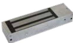
Электромагнитный замок/ 395-2 - с Датчиком Холла, 12V DC, 0,65 А, усилие 500 кг., габаритные размеры 267x70x45 мм. Масса брутто 5500 г. Алюминиевый корпус. Размер отсека блока электроники 52x63x36 мм. Уголок в комплекте. Механический компенсатор эффекта остаточной намагниченности на якоре замка. Влагозащита IP67 Сертификат. Цвет серый.
