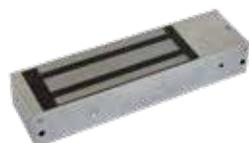
Электромагнитный замок/модель К - с Датчиком Холла, 12V DC, 0,64 А, усилие 500 кг., габаритные размеры 267x70x45 мм. Масса брутто 5500 г. Алюминиевый корпус. Размер отсека блока электроники 52x63x36 мм. Уголок в комплекте. Механический компенсатор эффекта остаточной намагниченности на якоре замка. Влагозащита IP67 Сертификат. Цвет коричневый.
