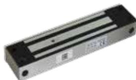
Электромагнитный замок, 12V/24V DC, не более 0,5 А, усилие 350 кг, габаритные размеры 220x46x27 мм. Масса брутто 2370 г, офисный дизайн, планка в комплекте. Влагозащита IP67 Сертификат. Геркон состояния замка. Механический компенсатор эффекта остаточной намагниченности на якоре замка.
