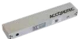
Электромагнитный замок, 12V/24V DC, не более 0,5 А, усилие 350 кг, габаритные размеры 253x50x28 мм. Масса брутто 2190 г., офисный дизайн, планка в комплекте, световая индикация, Датчик Холла положения замка (выход реле НО, НЗ). Механический компенсатор эффекта остаточной намагниченности на якоре замка.
